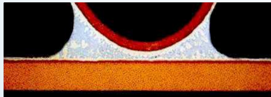
Połączenie rurki z żebrami
